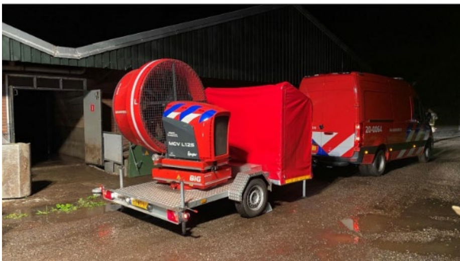
Figuur 3.5 Inzet ventilator door de brandweer bij een varkensstal (Bron: Team brandonderzoek Zeeland)
