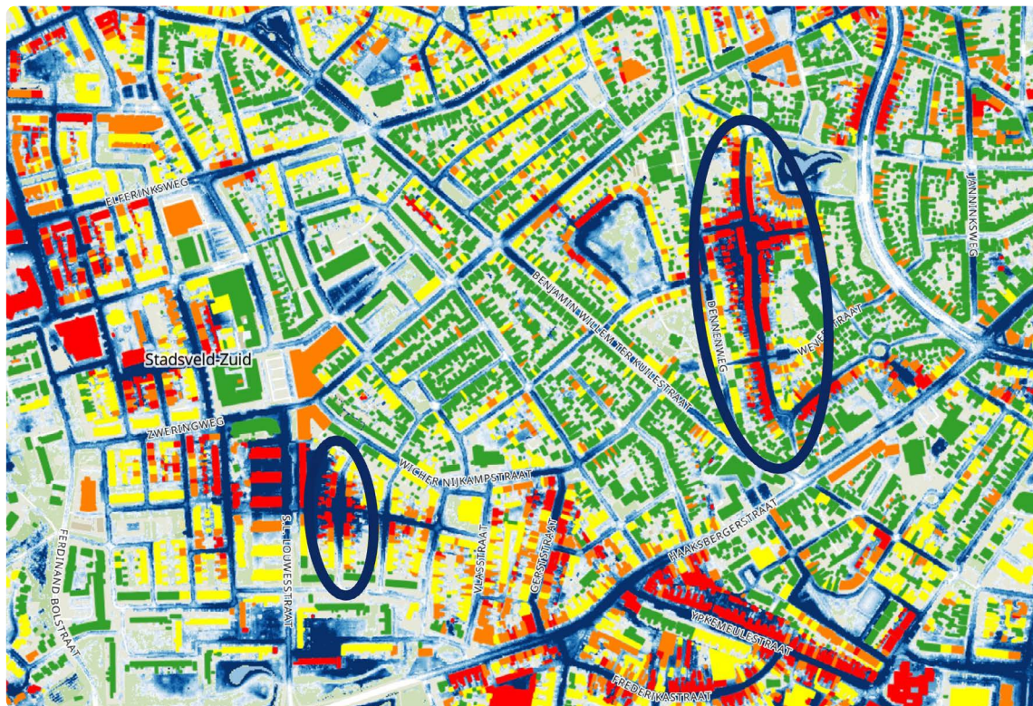
Figuur 28: Kaart van Pathmos (rechter zwarte cirkel) en Stevenfenne (linker zwarte cirkel). De kaart laat de waterdiepte zien bij een regenbui van 70 millimeter per uur (een kans van ongeveer eens in de 100 jaar dat deze voorkomt bij het klimaat in 2050). Donkerblauw betekent dat er >25 cm water staat. De kaart laat tevens voor binnendringend water kwetsbare panden zien. Dit is bepaald op basis van het aantal centimeters water tegen de gevel. Rood is grote kans, groen is geen kans (bron: Klimaatatlas van Twents Waternet).
